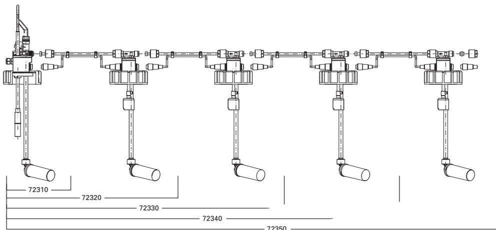
Die Servicepakete werden für Tankhöhen bis 1.850 mm geliefert und für Tankmittenabstände 780 mm.
